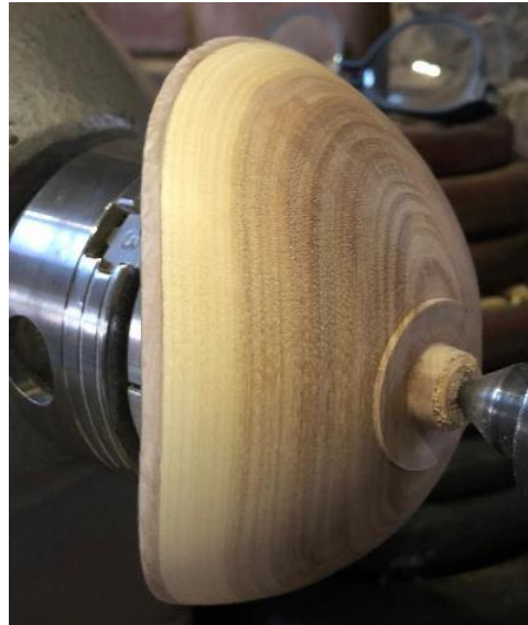
Verwydering van die bak se voetjie. / Removal of the bowl's foot.
